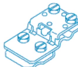
Párhuzamos összekötő kódszám: K2 (öntött)
